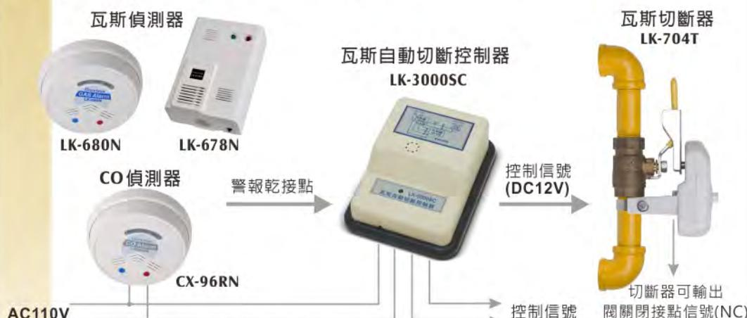
註：當瓦斯或一氧化碳外洩濃度在警報設定點以上時，瓦斯或一氧化碳偵測器警報並輸出至瓦斯自動切斷控制器，同時控制器輸出DC12V至瓦斯切斷器，關閉瓦斯開關閥。
